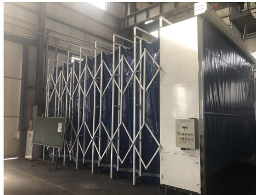
综掘机喷漆房及喷漆废气UV光氧催化处理设施
